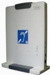
Переносная информационная система "Исток А1" и "А2" состоит из микрофона и передающей панели
